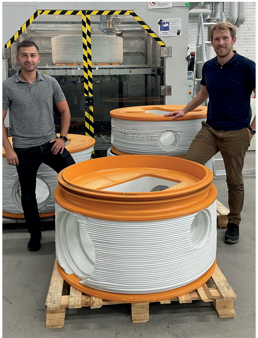
Kevin Winter (links) und Jonas Wilfert von Rehau in ihrer 3D-Druck-Produktionsumgebung. Die Bauteile können maximal einen Durchmesser von 1,2 m und eine Höhe von 85 cm haben © Rehau
